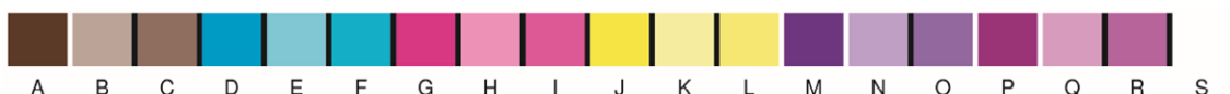
図 4 左から順番に、PANTONE 469 C、シアン、マゼンタ、イエロー、PANTONE 267 C、PANTONE 248 C、そして用紙の紙白の色票が並んでいる。100%の他に 40%と 70%の色票が各色に配置されている。掛け合わせの色票は全く含まれていない。色票の数はわずか 19 個しかない。
