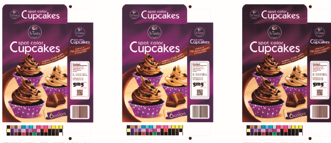
図 5 左から GMG OpenColor を使用したインクジェットブルーフ、オフセットの印刷物、従来のインクジェットブルーフ
